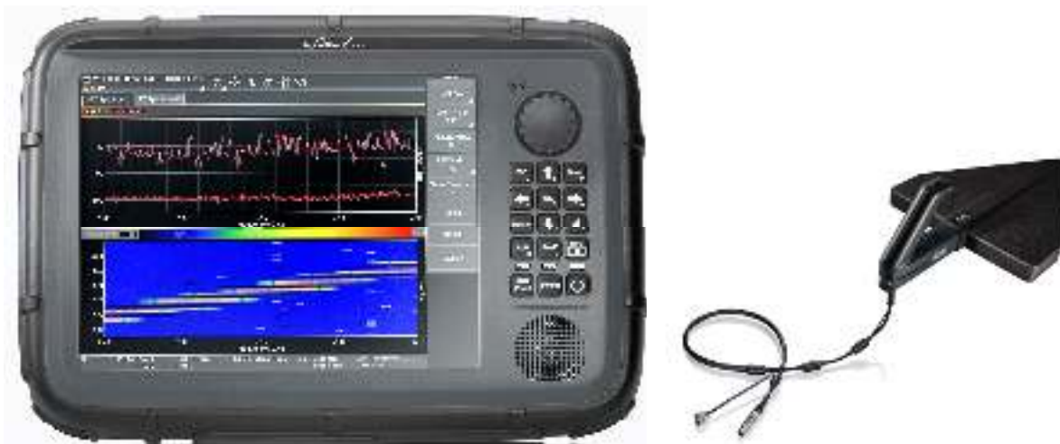
Bild 2-1: SignalShark Analysator mit Handpeilantenne
