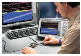
Der tragbare Signalanalysator SignalShark detektiert, analysiert, klassifiziert und lokalisiert HF-Signale zwischen 8 kHz und 8 GHz. (Bild: Narda STS)
