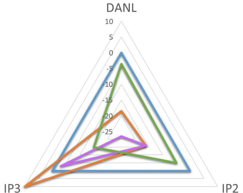
**Bild 4:** Spezifikationen Anritsu MS2720T (orange), R&S FSH (violett), R&S PR100/DDF007 (grün)
