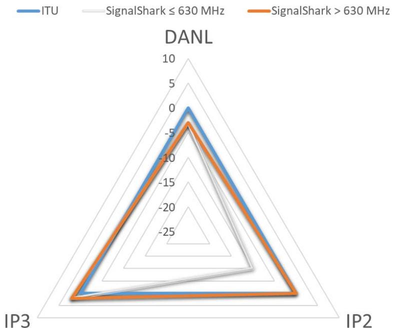
**Bild 3: Dynamikparameter SignalShark im Vergleich zu den ITU**
