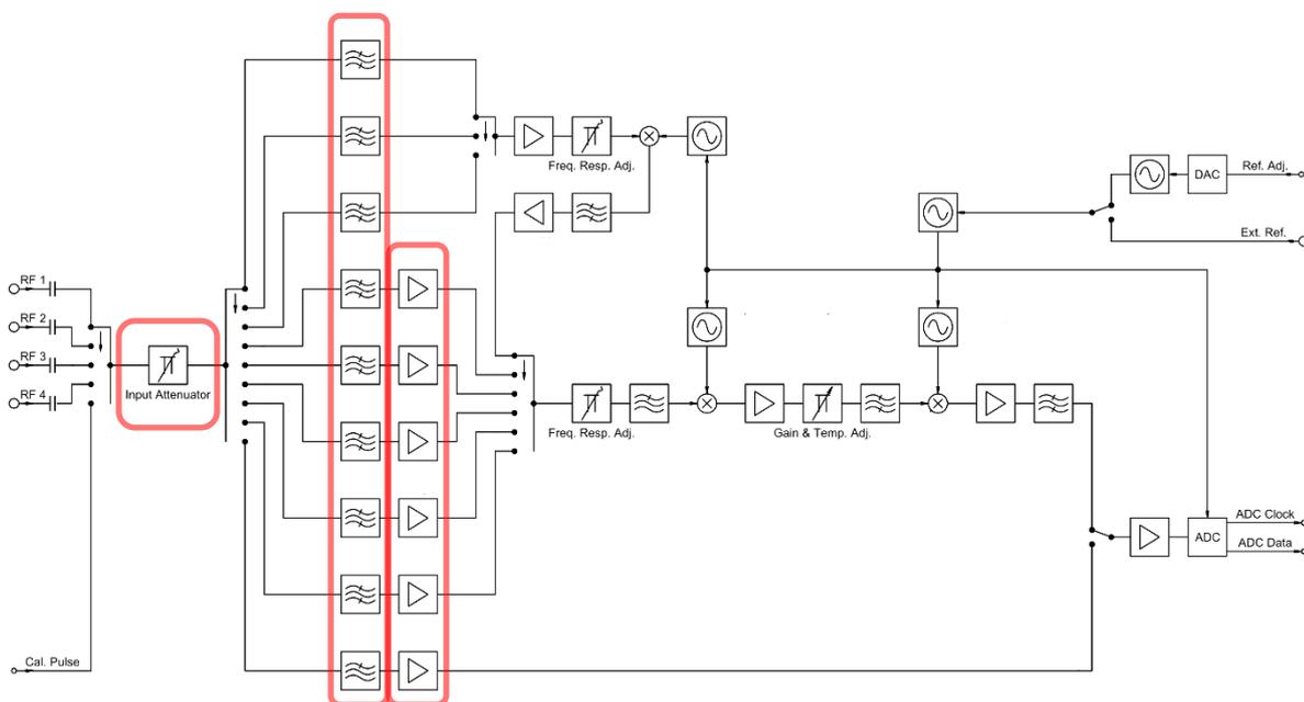
**Bild 6: Performantes RF-Frontend des SignalShark – Hohe Dynamik durch Filterbank (Mitte), hochwertige ZF-Verstärker (rechts) und Dämpfungsglieder, die sämtliche Frequenzpfade abdecken.**
