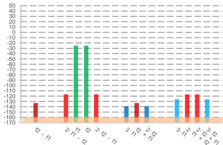
**Bild 7: SignalShark Dynamik bei Signalen 19 MHz, 21 MHz, je -18 dBm**
