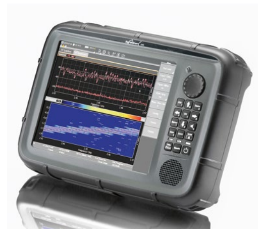
BILD 2 Die gesamte Intelligenz sitzt, abgesehen vom elektronischen Kompass, integriert in einem einzigen Gerät (© Narda STS)
