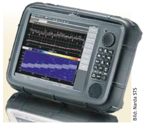
Bild 3: Durch den Einsatz des neuen Narda SignalShark konnte TE den Frequenzbereich für die Leistungstests von 3 auf 8 GHz erweitern. Parallel hat sich das gesamte Handling der mobilen Antennen-Tests insofern signifikant verschlankt, als jetzt die „gesamte Intelligenz“ – abgesehen von dem elektronischen Kompass – in Form eines leistungsfähigen Computers integriert in einem einzigen Gerät sitzt.
