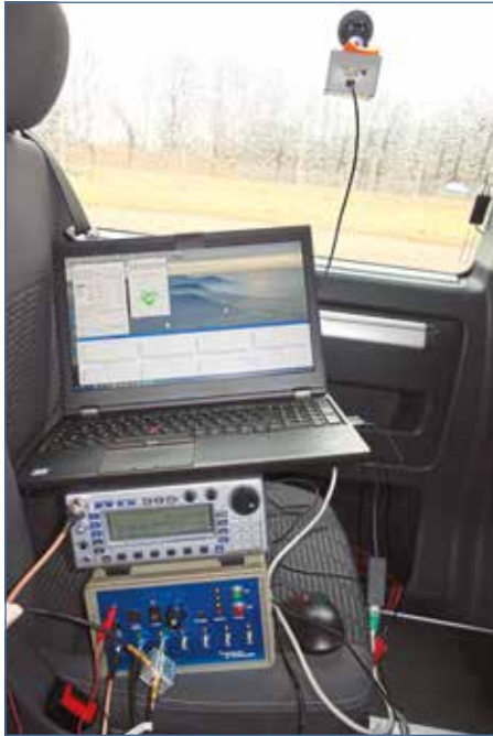
Bild 2: Die ursprünglich für die Leistungstests der verschiedenen Antennen eingesetzte HF-Messtechnik-Lösung bedeutete eine große, aufwendig verkabelte Konstruktion aus einem bis 3 GHz ausgelegten Messempfänger und separaten HF-Switch, einem zusätzlichen Laptop und externen Gyrosensor.
