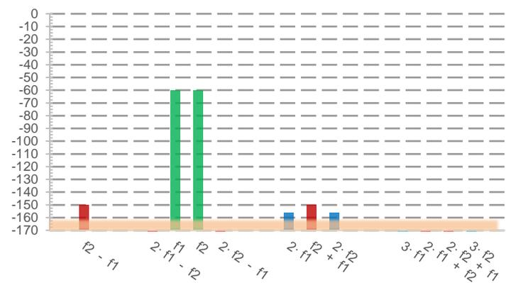
**Bild 17: Absenken RBW auf 1 Hz, Signal -60 dBm, Att 0 dB, RL -10 dBm
