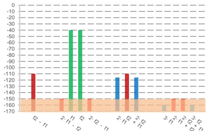
**Bild 15:** Keine Artefakte 3. Ordn., Signal -40 dBm, Att 0 dB, RL -10 dBm
