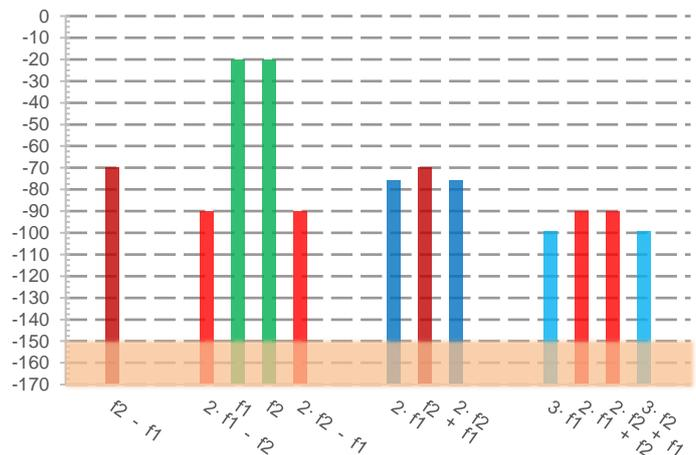
**Bild 14:** Nach Att-Anpassung, Signal -20 dBm, Att 0 dB, RL -10 dBm
