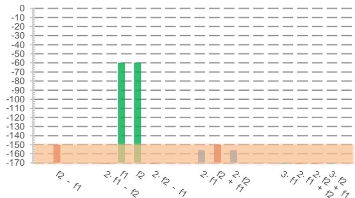
**Bild 16: Keine Artefakte 2. Ordn., Signal -60 dBm, Att 0 dB, RL -10 dBm
