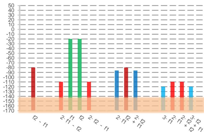
**Bild 4: Ausgangssituation, Signal -20 dBm, Att 10 dB, RL 0 dBm**
