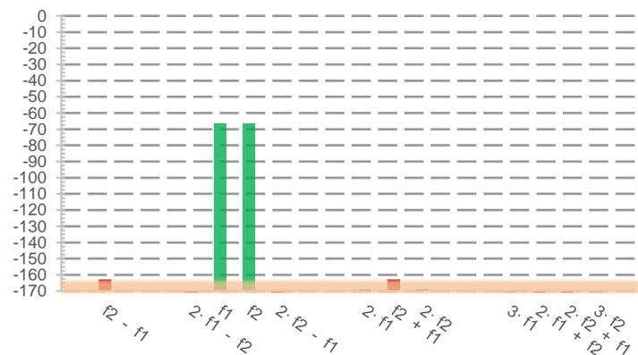
**Bild 18: Keine Artefakte 2. Ordn., Signal -66,5 dBm, Att 0 dB, RL -10 dBm
