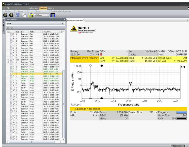
*Bild 1: Beispiel für einen Screenshot. Durch die Screenshot-Funktion kann man Messergebnisse direkt in Messberichte einfügen und hat auf einen Blick numerische Werte und grafische Darstellungen. Die Screenshots lassen sich auch an E-Mails anhängen, um sie zu verteilen und zu diskutieren.*
