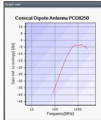
**Bild 2: Grafische Darstellung von Antennenfaktoren. Sie lassen sich in der PC-Software direkt editieren.**
