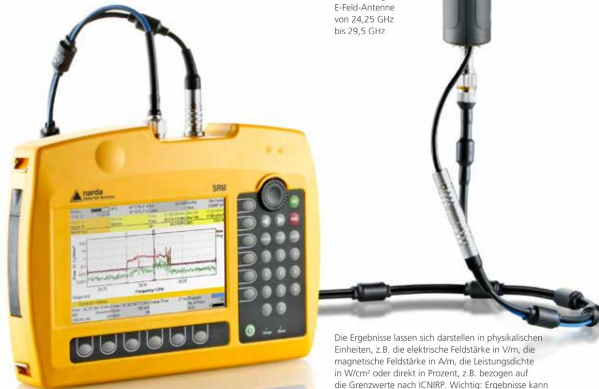
Die Ergebnisse lassen sich darstellen in physikalischen Einheiten, z.B. die elektrische Feldstärke in V/m, die magnetische Feldstärke in A/m, die Leistungsdichte in W/cm<sup>2</sup> oder direkt in Prozent, z.B. bezogen auf die Grenzwerte nach ICNIRP. Wichtig: Ergebnisse kann der SRM auch nachträglich in Prozent, physikalische Einheiten oder logarithmische Maße umrechnen.
