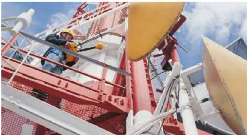
Trotzdem sind die Spezifikationen des SRM-3006 so, dass es sich auch im Labor sehen lassen kann: Mit einer ungewöhnlich großen maximalen Bandbreite von 32 MHz, einem für Handgeräte exzellenten Rauschabstand und den Standard-N-Connector, über den sich Antennen und Kabel anderer Hersteller anschließen lassen.
