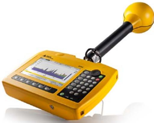
**Bild 2:** Der SRM-3006 (Selective Radiation Meter) von Narda Safety Test Solutions, den Dr. Christian Bornkessel für die Messungen einsetzte
