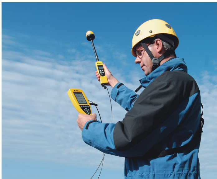
Sondenverlängerung über optisches Kabel. Das NBM-550 wird als Steuergerät verwendet und zeigt die Ergebnisse. Das kleine NBM-520 dient als optisches Sondeninterface. Beide Geräte können aber auch völlig unabhängig voneinander mit Messsonde eingesetzt werden.
