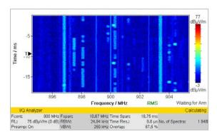
Bild 7: Beispiel eines Spektrogramms mit (künstlich erzeugter) Intermodulation.
