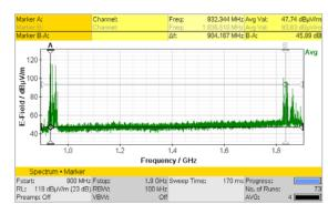
Bild 1: Übersicht über den Frequenzbereich von GSM 900 und GSM 1800. Das Spektrum zeigt viele Frequenzen, deren Differenz in den Uplink-Bereich von GSM 900 fallen können. Beispiel (Marker A u. B): 1836 MHz\_down – 932 MHz\_down = 904 MHz\_up. Die Feldstärken von mehr als 100 dBµV/m reichen auch aus, um Intermodulationen an nichtlinearen Gebilden zu erzeugen.
