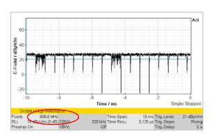
Bild 6: Der Zeitverlauf des Signals bei 896,6 MHz zeigt die typische Struktur eines BCCH im GSM-Downlink mit seinen Zeitschlitzen. Alle Schlitze sind belegt, einer von ihnen mit einem "zappelnden" EDGE-Signal.
