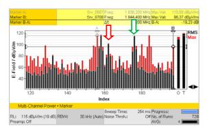
Bild 2: Multi-Channel-Power-Messung im GSM-1800-Downlink-Band, Bargraph-Darstellung. Steuerungsund Verkehrskanäle (BCCH und TCH) lassen sich eindeutig an dem Unterschied zwischen RMS- und MAX-Werten erkennen.
