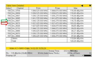
Bild 3: Listenübersicht, geordnet nach Maximalpegeln. Wegen der unterschiedlicher Aufnahmezeit differieren Bargraph und Liste.
