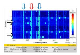
Bild 5: Spektrogramm. Ausschnitt aus dem GSM-900-Uplink-Band. Die starken, andauernden Signale sind untypisch für die Uplink-Richtung.
