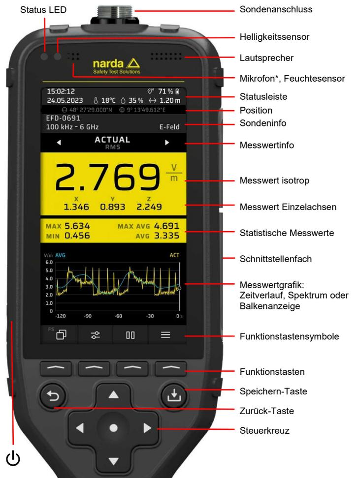
Abb. 2. Anzeige und Bedienelemente des FieldMan
