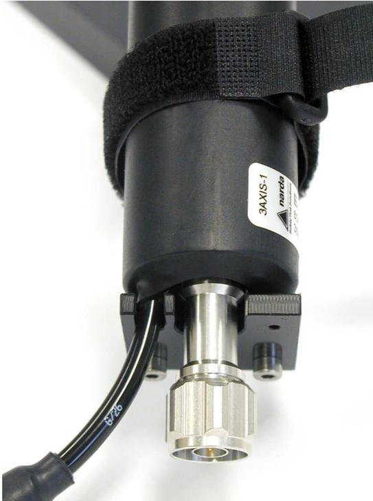
Bild 6: Kabel und N-Connector in der Führungsnut
