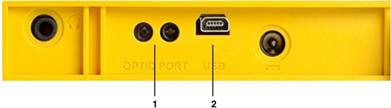
Bild 46: Optische Schnittstelle (1) und USB-Schnittstelle (2)
