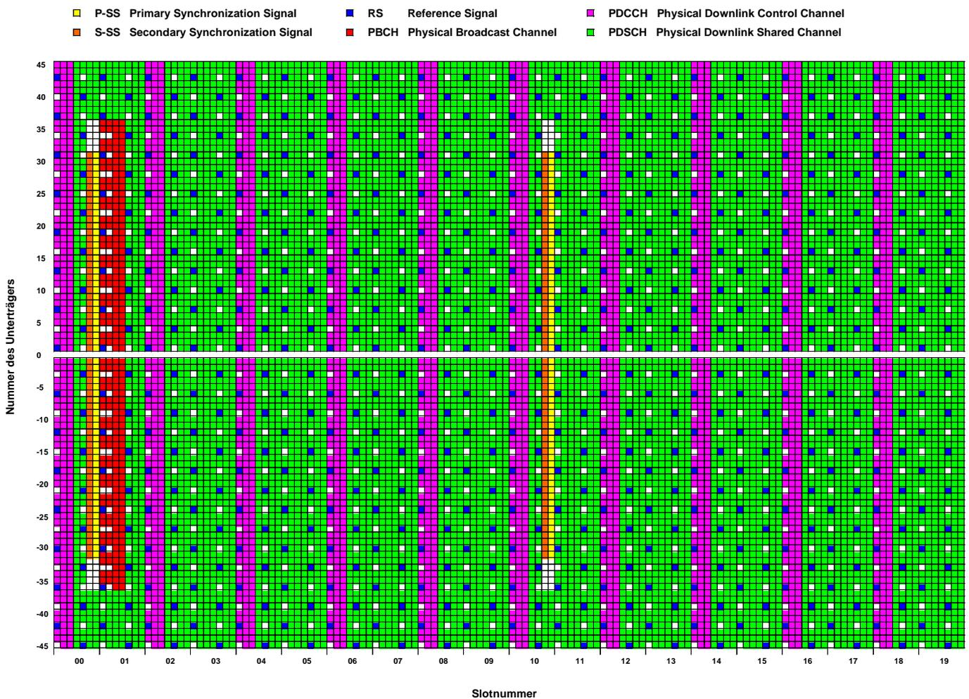
abgestrahlt werden. Die RS belegen dabei für beide Antennen unterschiedliche Positionen im Resource Grid, siehe Bild 2 [ETSI 136.211]: In einem Symbol ist jeweils der mittlere Unterträger zwischen zwei RS ausgetastet; an genau dieser Stelle befindet sich der RS der anderen Antenne. Diese verschachtelte Anordnung ermöglicht es dem LTE-Endgerät (bzw. im vorliegendem Fall dem codeselektiven Messgerät) zu erkennen, ob das empfangene RS-Element von Antenne 0 oder Antenne 1 stammt.
