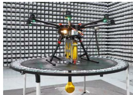
Abb. 2: Drohne auf dem Start-POD mit Antenne montiert
