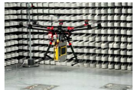
Abb. 3: Fliegende Drohne oberhalb des Prüfdrehtellers mit aktiver Messgerätesteuerung bei Störfestigkeitsuntersuchung (ohne isotrope Antenne)
