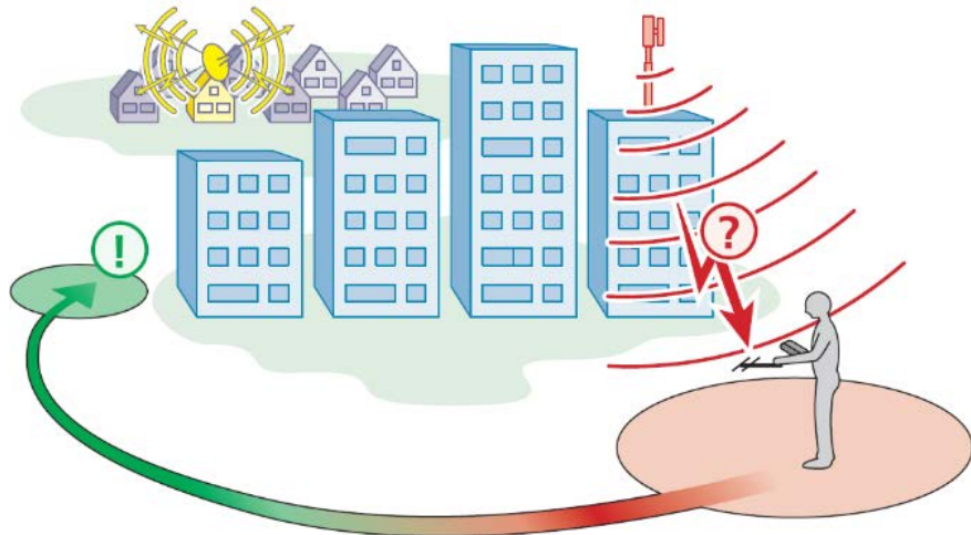
Bild 11: Änderung des Messstandortes zur Vermeidung starker Downlink-Signale
