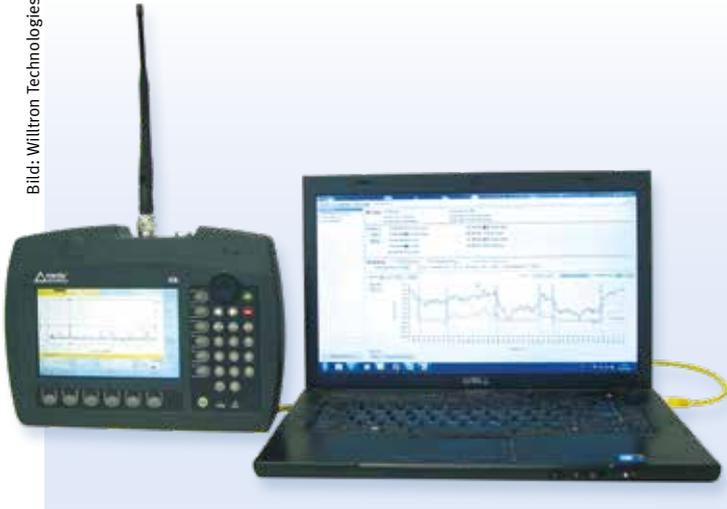
**Bild 1:** Der IDA2 (Interference and Direction Analyzer) von Narda wird über Ethernet und RJ45-Steckverbinder mit dem DTS-3000 verbunden.
