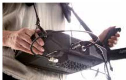
Sollte IDA 2 trotz seines großen Dynamikbereichs einmal durch starke Sender „elektronisch geblendet“ werden, steht eine große Auswahl externer Filter zur Verfügung. Dank deren kompakter Bauform und passendem Mounting Kit ist damit der tragbare Einsatz des IDA 2 uneingeschränkt möglich.
