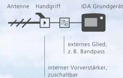
Dank der Übersteuerungsfestigkeit des Vorverstärkers lässt sich ein Filter hinter dem Vorverstärker und vor dem Grundgerät einfügen. Alle relevanten Übertragungsfaktoren der Signalkette, vom Wandlungsmaß der Antenne über Vorverstärker, Filter, externe Dämpfungsglieder und HF-Kabel kann der IDA2 speichern und zusammen mit der Übertragungsfunktion seines Eingangsteils in den angezeigten Messwerten berücksichtigen.
