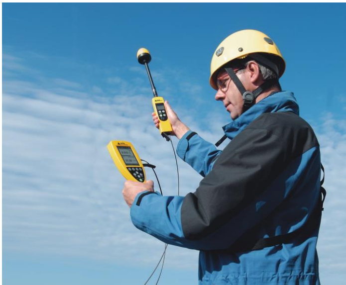
Sondenverlängerung über optisches Kabel. Das NBM-550 dient als Steuergerät und zeigt die Ergebnisse. Das kleine NBM-520 dient als optisches Sondeninterface. Beide Geräte können aber auch völlig unabhängig voneinander mit Messsonde eingesetzt werden.
