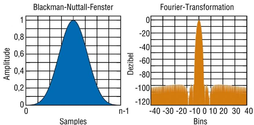
Das Blackman-Nuttall-Fenster (links Zeitbereich, rechts Frequenzbereich) selektiert besser als das in Spektrumanalysatoren übliche Gauß-Filter und hat eine sehr gute Unterdrückung der Seitenlinien. Mit entsprechender zeitlicher Überlappung werden auch schmale Pulse gut verarbeitet.
