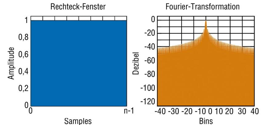
FFT mit Rechteck-Fenster, d.h. ohne Bewertung der zeitlichen Abtastwerte (links). Ein transformierter Sinus zeigt im Frequenzbereich hohe Seitenlinien, vor allem in direkter Nähe der eigentlichen Frequenz (rechts).
