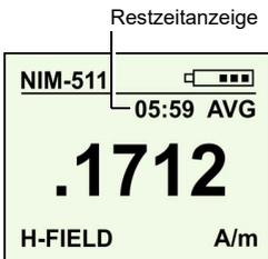
Beide Mittelungsarten führen zum selben Ergebnis. Die Mittelung ist konform zu den gängigen Sicherheitsstandards für hochfrequente Felder und erfolgt üblicherweise über eine Dauer von 6 Minuten. Die Messwerteinheit kann zu jeder Zeit umgeschaltet werden, ohne dabei die bereits gemittelten Ergebnisse zu beeinträchtigen.
