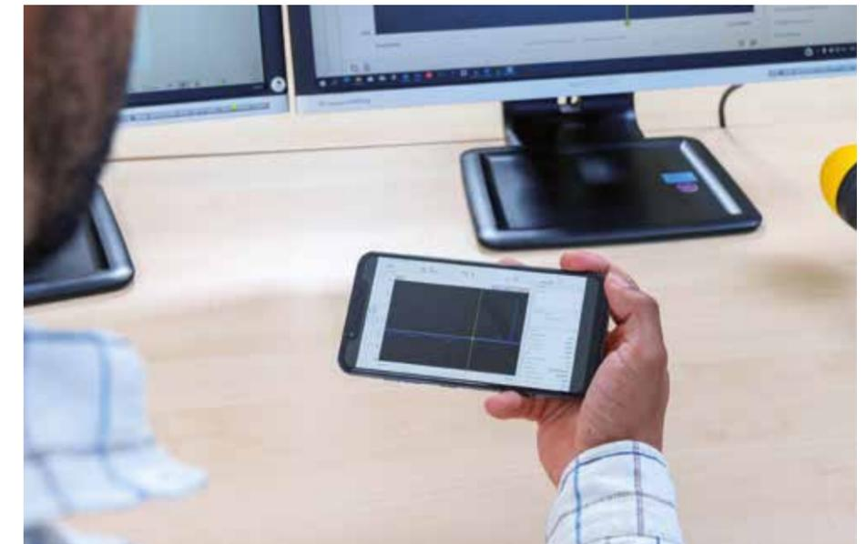
Die WiFi/Bluetooth-Schnittstelle erlaubt über die optionale Smartphone-App die Fernbedienung des FieldMan. Dadurch lassen sich beispielsweise Fotos und Videos anfertigen, die den Messdaten hinzugefügt werden können.
