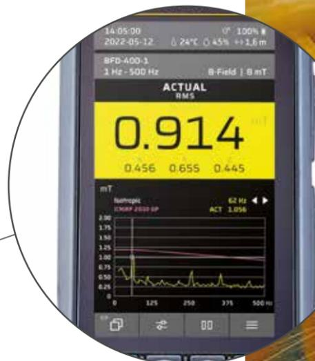
Magnetfelder sind im Gegensatz zu elektrischen Feldern nicht leicht abzuschirmen. Die neuen H-Feld-Sonden von Narda messen magnetische Felder richtungsunabhängig und lassen sich durch ihre geometrisch angeordneten Spulen einfach positionieren.
