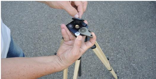
3. Fixez l'adaptateur à l'ADFA au niveau du trou central (voir l'étiquette rouge sur l'image ci-dessous) et serrez-le à l'aide d'un outil approprié (par exemple, un tournevis, une pièce de monnaie).
