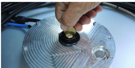
4. Monte el adaptador con la ADFA en el cabezal del trípode:
