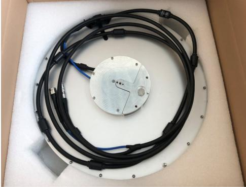
图 1: 包装内的 ADFA 和 RF 电缆已连接。
