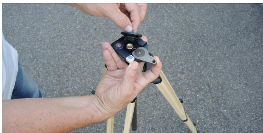
3. 将适配器连接到中心孔位置的 ADFA (参见下图中的红色标签) 并使用合适的工具上紧 (例如螺丝刀、硬币)。
