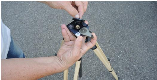
3. Bringen Sie den Adapter an der ADFA im Mittelloch an (siehe rote Markierung auf dem Bild unten), und ziehen Sie diesen mit einem geeigneten Werkzeug (z.B. Schraubendreher, Münze) fest.
