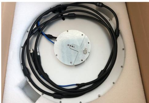
Figura 1: Embalaje equipado con una ADFA y un cable RF ya conectado.
