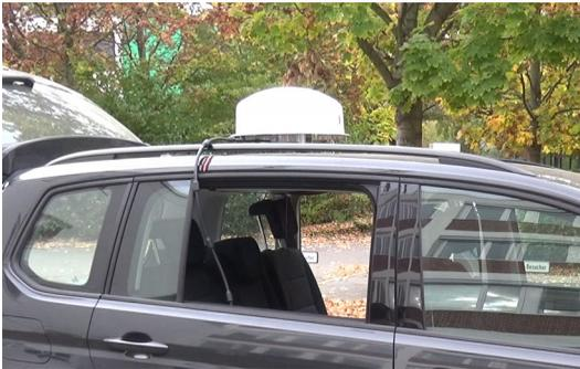
Figura 6: ADFA montada con la correa de seguridad y el cable RF enrutado.
