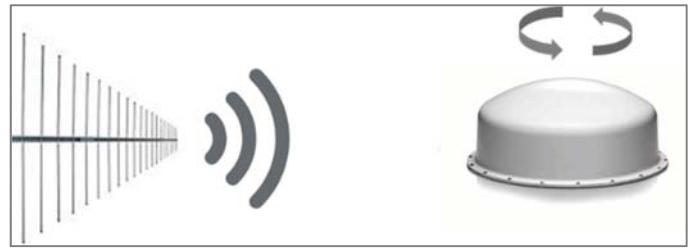
Abb. 5. Zur Ermittlung des Katalogs wird die Antenne bei verschiedenen Frequenzen im Messfeld gedreht.
