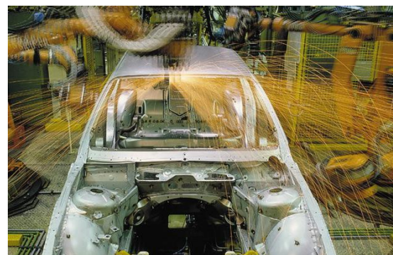
电阻焊接机生产中
