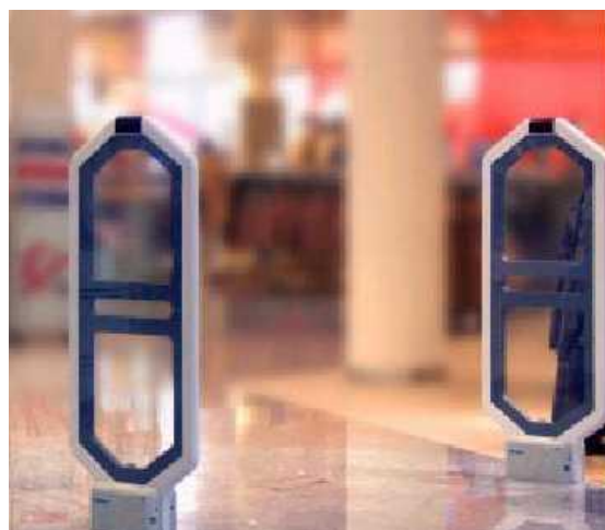
货品监管中使用的磁感应门
