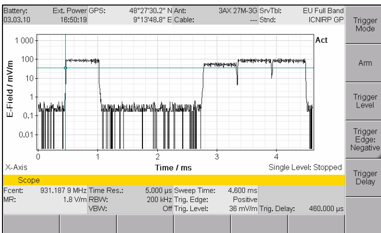
Bild 6: In der Betriebsart Scope zeigt das SRM-3006 die momentane Auslastung der Time Slots innerhalb des TCH.
