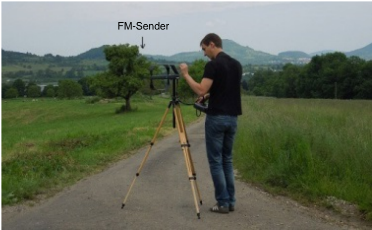
Bild 3: Aufnahme eines Horizontal Scans auf einer freien Fläche. Die Bedingungen zum Peilen des FM-Senders sind ideal. Versuchsweise wurde hier die vertikale Polarisationsrichtung gewählt. In der Regel sind DAB-Sender vertikal, analoge FM-Sender horizontal polarisiert.
