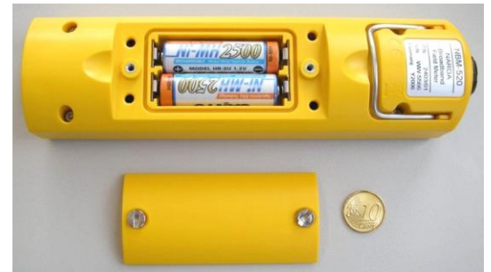
使用硬币就可容易打开电池盒，仪器由四个可充电镍氢电池（AA 型）进行供电
