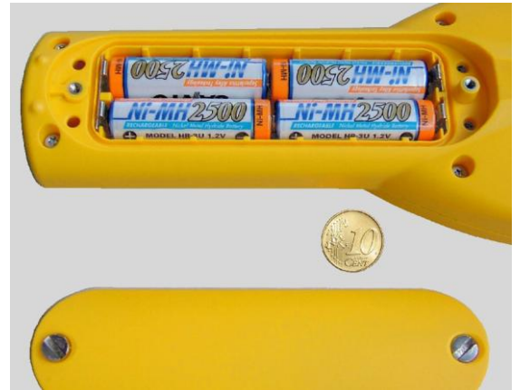
上图：使用硬币就可容易打开电池盒，仪器由四个可充电镍氢电池（AA 型）进行供电
