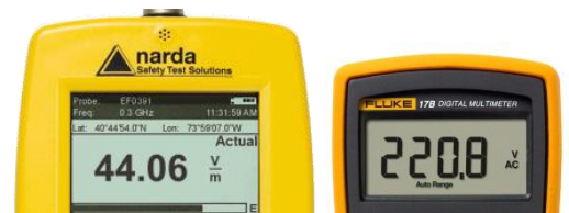
Bild 2: Messwertanzeigen im NBM erfolgen immer als RMS-Werte genau wie bei einem Multimeter.
