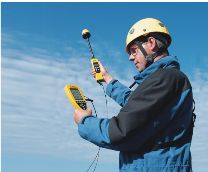
探头延长需使用光纤：NBM-550 作为控制器并显示测量结果，小型的 NBM-520 作为光纤探头接口。当配备合适的测量探头时，二者也可以作为独立的测量仪器使用。
