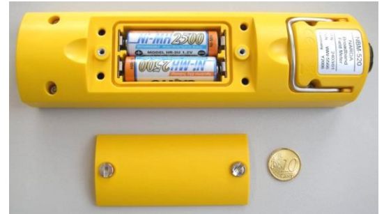
使用硬币即可打开电池盒，仪器由四个可充电镍氢电池（AA 型）进行供电
