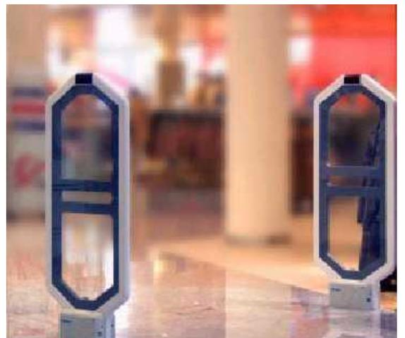
*Akustomagnetische Anlage zur Warensicherung*
