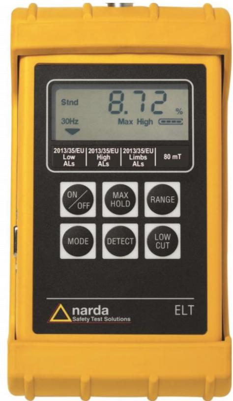
*Die Betriebsart Exposure STD ermöglicht die direkte Anzeige der Grenzwertausschöpfung in Prozent*
