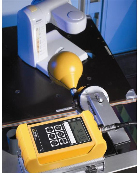
*Normenkonforme Messung von Haushaltsgeräten*
