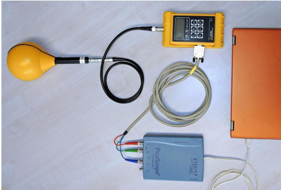
Abbildung 2: Messgerät ELT-400 mit USB-Datenlogger PicoScope 4424 und angeschlossenem Laptop
