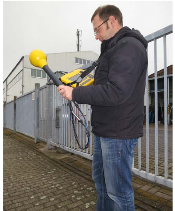
Bild 2: LTE-Messung mit dem SRM-3006 und einer isotropen Antenne.
