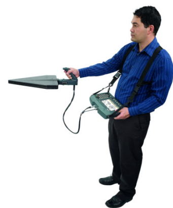
Bild 9. Durchführung eines Horizontal Scan mit IDA-3106 zur Peilung eines Senders
